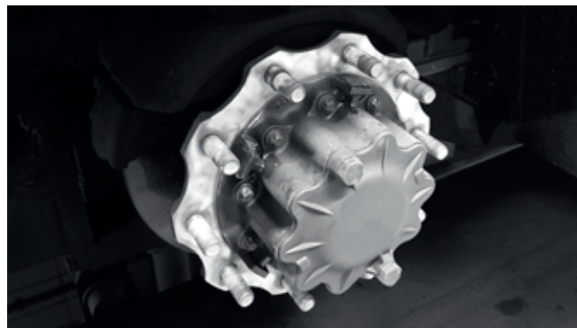
13-46. kép Csillag alakú kerékagy
