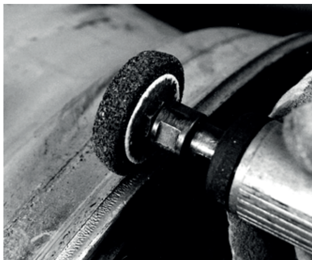
13-32. kép Levegős vagy elektromos sarokcsiszoló Egy másik gyors és hatékony módszer a felni peremének kopása által okozott éles szél eltávolítására. Legyen óvatos, mert a csiszolókorongok eltömődhetnek az eltávolított alumíniumtól. Ügyeljen arra, hogy ne marjon bele a kerékbe.
