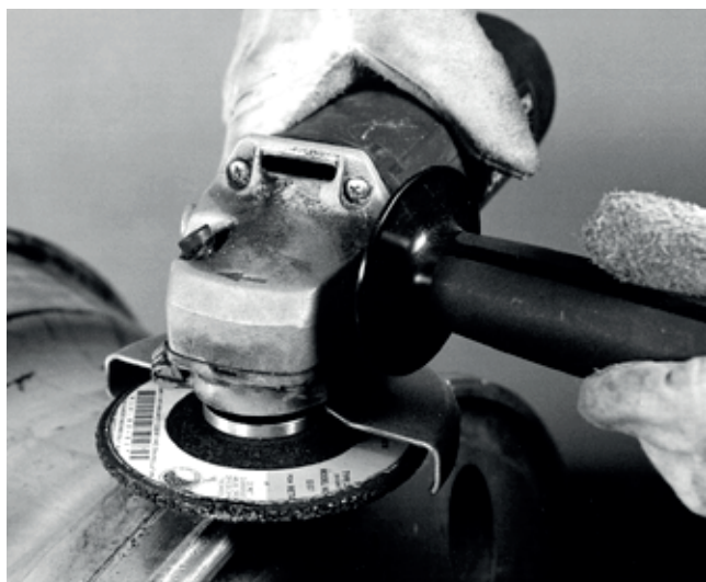
13-33. kép Sarok-multicsiszoló Csiszolókoronggal, vágókővel vagy csiszolószerszámmal használva ez az elektromos sarokcsiszoló egyik változata. Ez az eszköz nagyon gyors és egyben hatékony. A fémet a lehető legegyszerűbben távolítsa el, és ne marjon a kerékbe.
