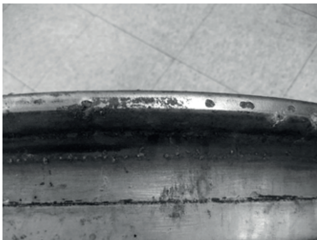
13-37. kép Elfogadható kopás és bemaródás
